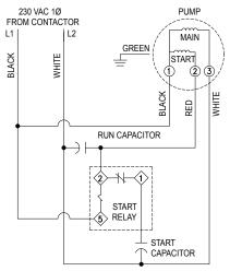
MODELS X6111 / X6122 / X6123 / X6124 AND X6120 / X6121 USING GE RELAY AFTER 10/1/07
